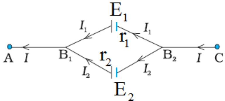
$$V_{AC} = E_1 - I_1 r_1 = E_2 - I_2 r_2$$
